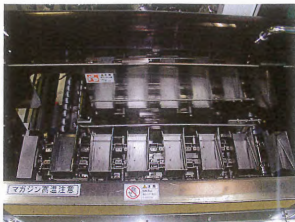
洗浄機搬送部
