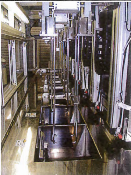
洗浄機搬送部
